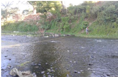
Gambar 8. Tata Cara Pengukuran Geometri Sungai Brang Biji
