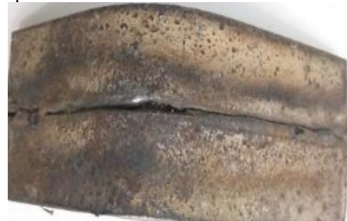
Gambar 4. Hasil uji bending pengelasan 80A
