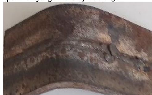
Gambar 5. Hasil uji bending pengelasan 90A
