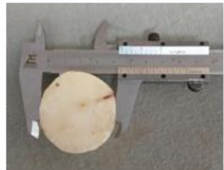
Gambar 1. (a) posisi awal pengiris, (b) pengukuran diameter singkong
