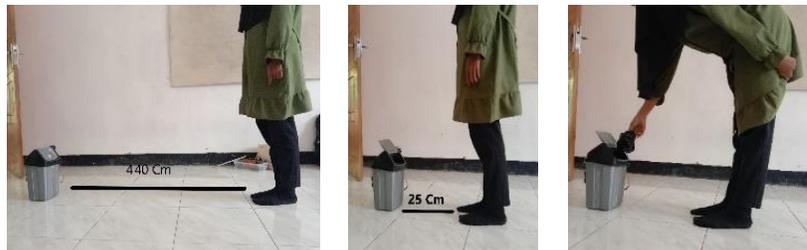
**Gambar 7.** Hasil Pengujian Sensor PIR dengan Servo Motor
